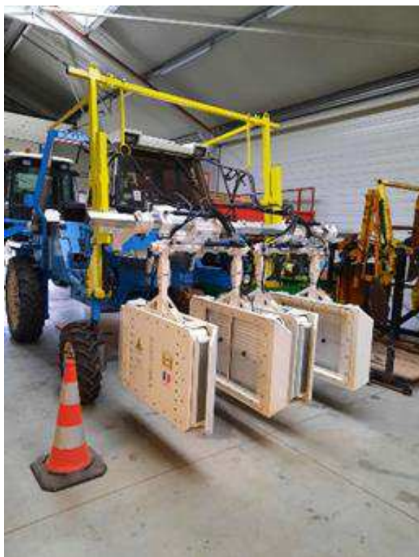
Links: tractor met UV-lampen om ziekten te bestrijden in de wijngaard en rechts een snoeiapparaat
