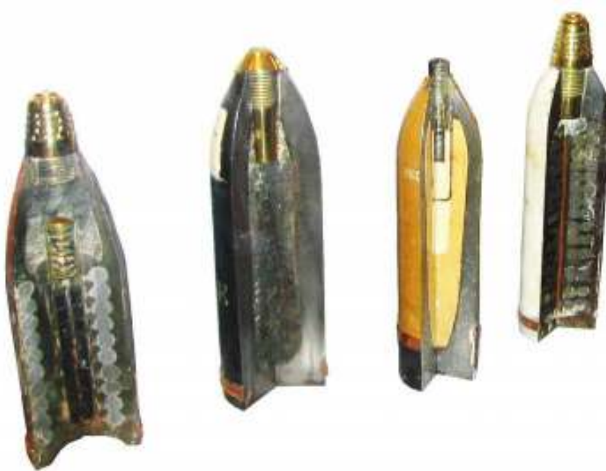
Doorsnedes van verschillende obussen: v.l.n.r. 90 mm splinterbom (shrapnel), 120 mm bom voor fosgeen (brand) of chemische gasen, 75 mm explosiebom en 75 mm splinterbom (shrapnel) waarin men de metalen bolletjes ziet die bij de ontploffing alle kanten uitvliegen (bron: https://commons.wikimedia.org/wiki/File:WWI_shells.JPG )
